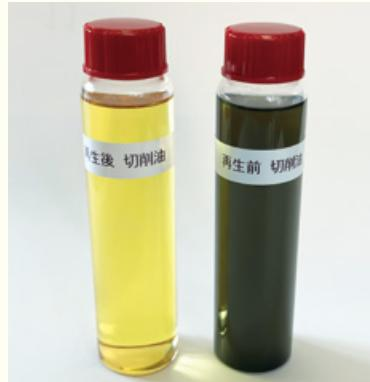
ア油、プレス油、切削油、熱処理油などの各種工業用潤滑油を預かり、再生処理して戻している。
